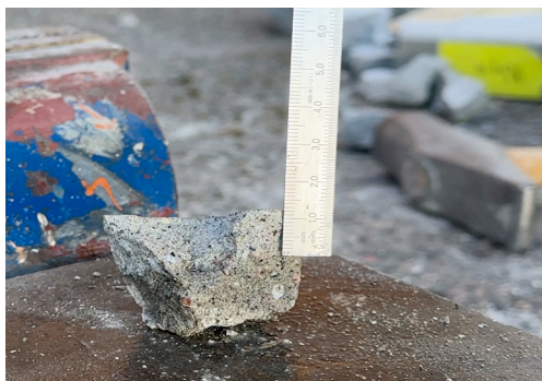
◀ Det finns olika metoder att verifiera hur långt in i betongen som impregneringen har kommit. Här har en borkärna knäckts och visar på att betongen är skyddad från inträngande fukt.
