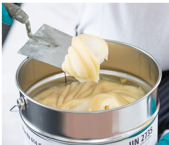
Komponent B är ett förfyllt epoxiharts som ger ytan dess struktur. Foto t.v. + titel: Martin Baitinger
