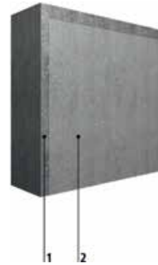
1 betongunderlag 2 hydrofoberande impregnering
