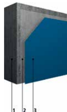
1 grundning 2 finbruk 3 beläggning
