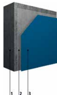
1 betongunderlag 2 grundning 3 beläggning
