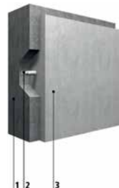
1 betongunderlag 2 Korrosionsskydd 3 lagningsbruk
